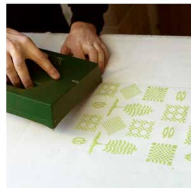
Die Resistpaste sorgt dafür, dass das Druckmuster nach dem Eintauchen in den Indigobottich ungefärbt bleibt.
