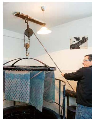
Der bedruckte Stoff wird auf einen speziellen Rahmen gespannt und in das Indigobad getaucht.
